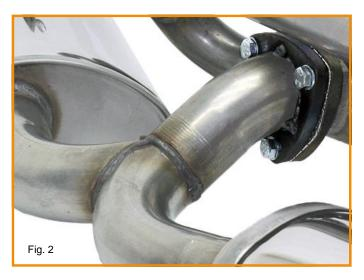
WICHTIG: Hier nicht zu stark anziehen, damit sich die Rohre nicht verformen und eine spätere Demontage möglich bleibt. Ein Einsatz von Kupferpaste ist an dieser Verbindung ebenfalls zu empfehlen.
